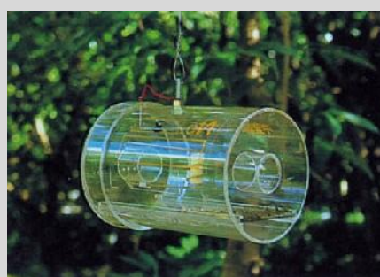
Рисунок 15. Стандартная ловушка Штайнера.
